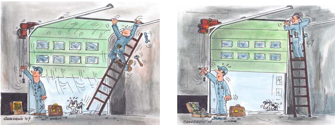
1. Si las hojas de puerta motorizadas pueden ser movidas manualmente, deben estar equipadas con un dispositivo de desconexión o interbloqueo (cuando se pasa a manual, el motor no debería funcionar).
