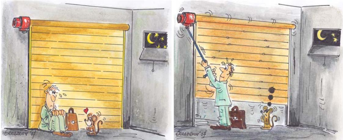
1. La persona atrapada entre dos puertas motorizadas, o en locales cuya única salida sea la puerta motorizada, debe tener la posibilidad de desplazar manualmente la hoja desconectando la motorización de la puerta, o
