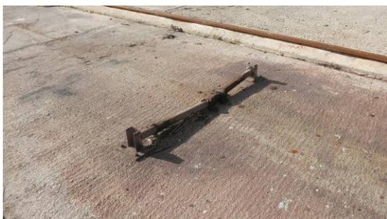
Fotografía 17. Apoyo giratorio de los cables del carro varadero aplastado.
