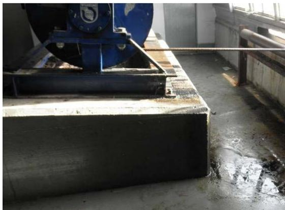
Fotografía 2. Vertido de aceite en la sala de máquinas del carro varadero.
